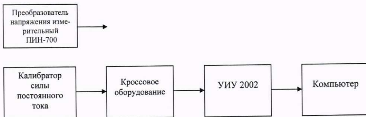
Рисунок 14 - Схема определения метрологических характеристик ИК среднеквадратичных значений напряжения переменного тока
