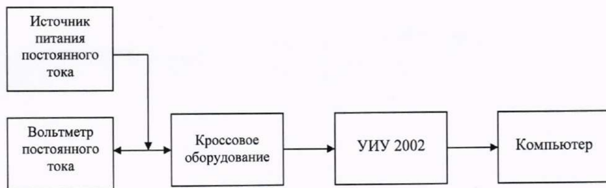
Рисунок 9 - Схема определения метрологических характеристик ИК напряжения постоянного тока
