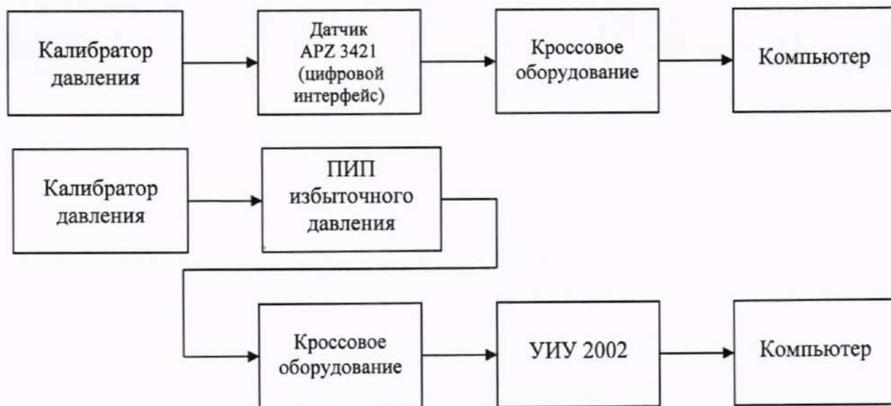
а) Схема определения метрологических характеристик комплектным способом
