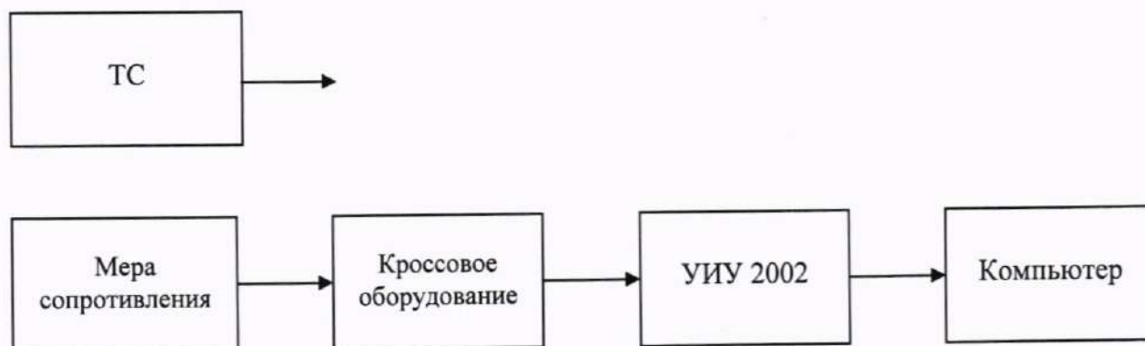
б) Схема определения метрологических характеристик поэлементным способом
