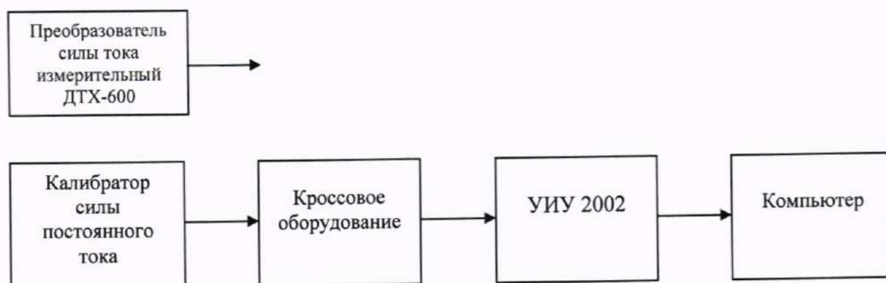
Рисунок 15 - Схема определения метрологических характеристик ИК среднеквадратичных значений силы переменного тока
