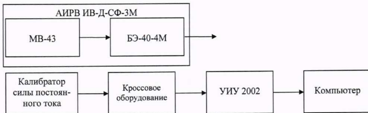
Рисунок 8 - Схема определения метрологических характеристик ИК виброскорости
