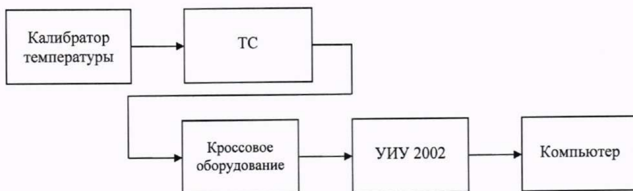
а) Схема определения метрологических характеристик комплектным способом
