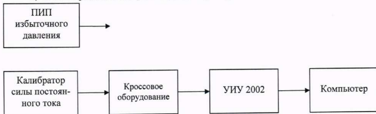
б) Схема определения метрологических характеристик поэлементным способом
