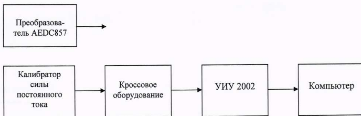
Рисунок 10 - Схема определения метрологических характеристик ИК напряжения постоянного тока (с преобразователями)
