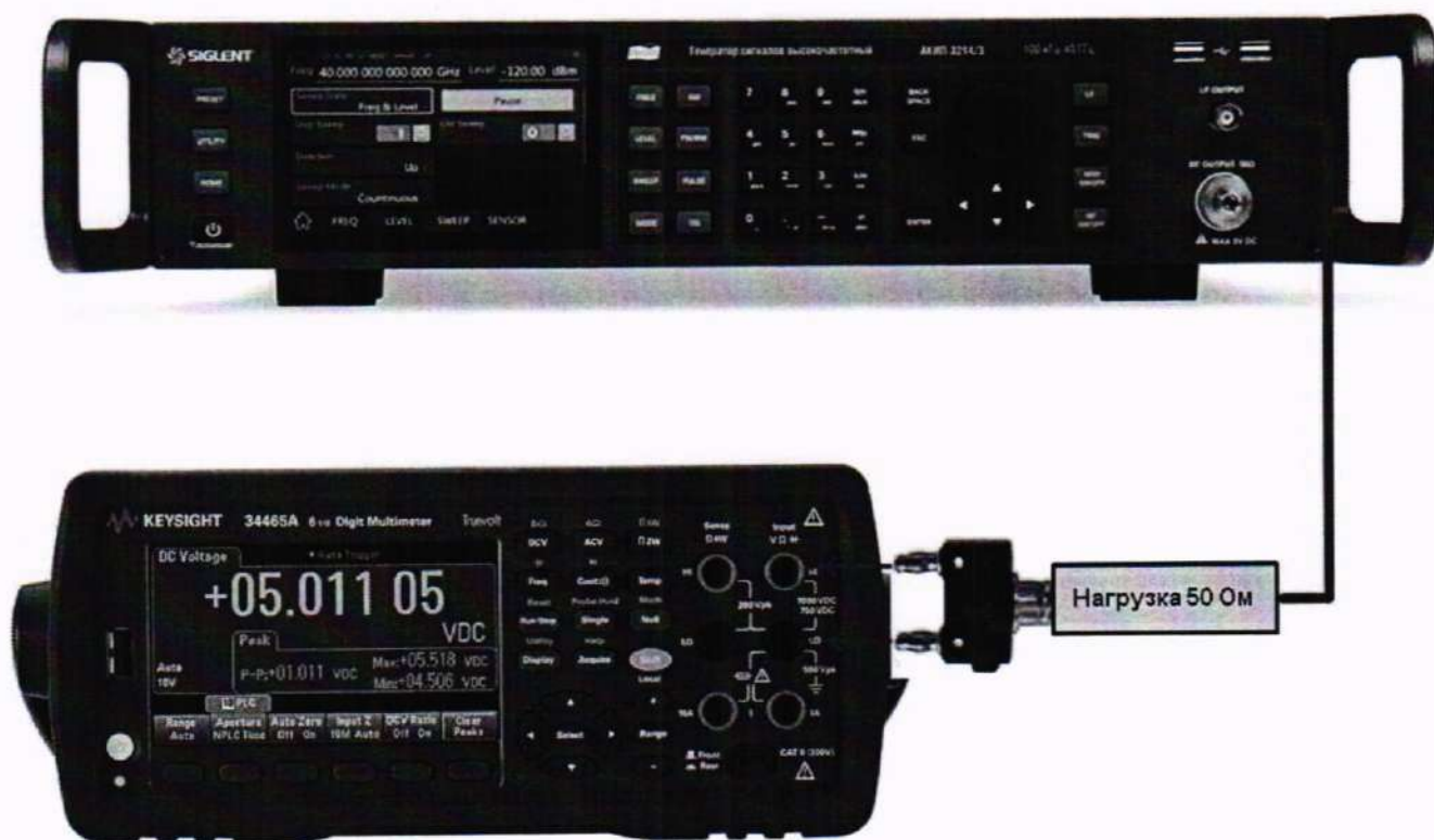
Рисунок 6 – Схема соединения приборов для определения погрешности установки уровня постоянного смещения
