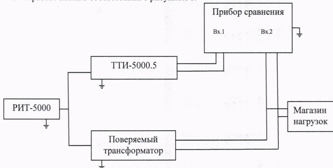
Рисунок 1 – Схема определения токовых и угловых погрешностей трансформаторов
