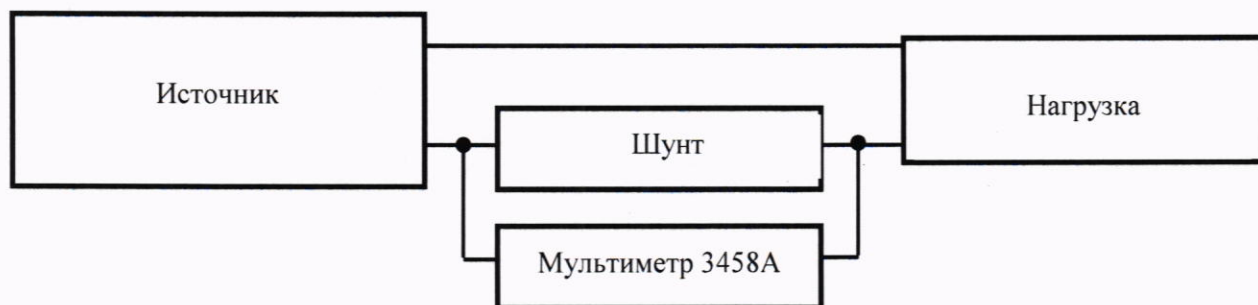
Рисунок 1 – Структурная схема определения абсолютной погрешности установки и измерений силы постоянного тока
