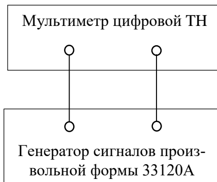
Рисунок 2 – Схема для определения абсолютной погрешности измерений частоты
