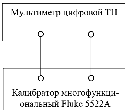
Рисунок 1 – Схема для определения метрологических характеристик
