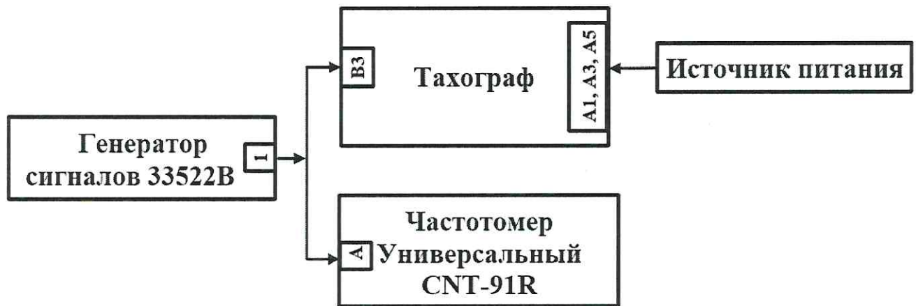
Рисунок 2 – Схема проведения измерений при определении абсолютной погрешности измерений интервала времени и абсолютной инструментальной погрешности измерений пройденного пути
