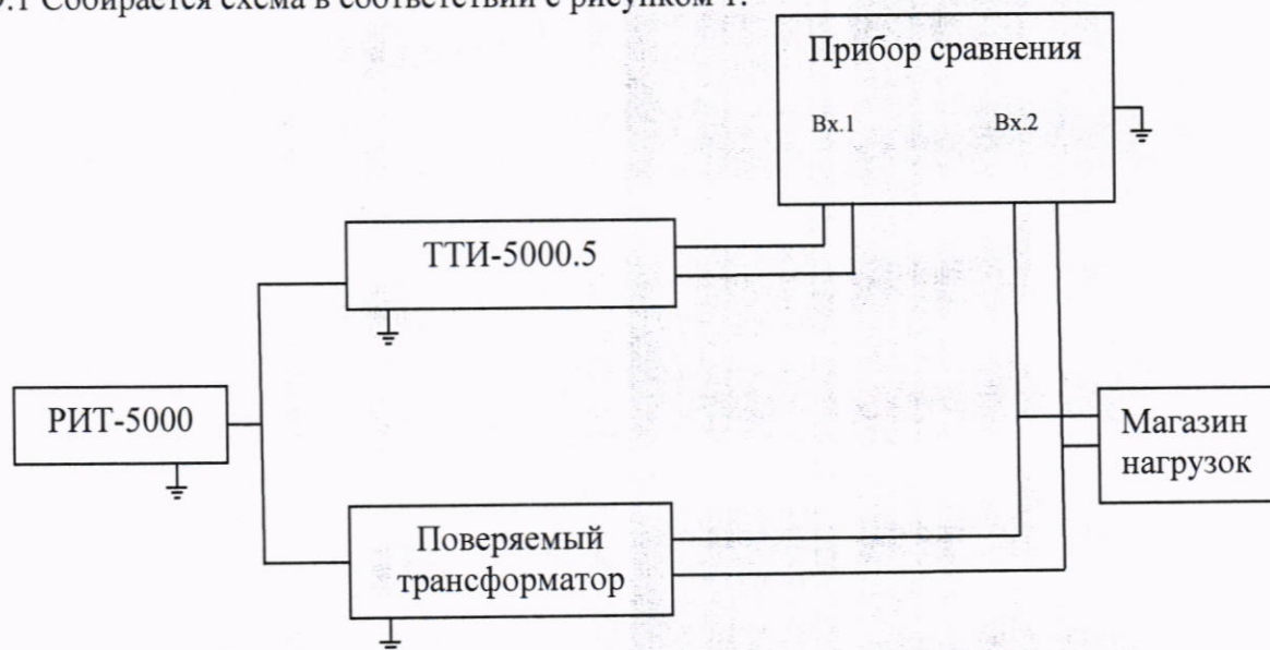
Рисунок 1 – Схема определения токовых и угловых погрешностей трансформаторов
