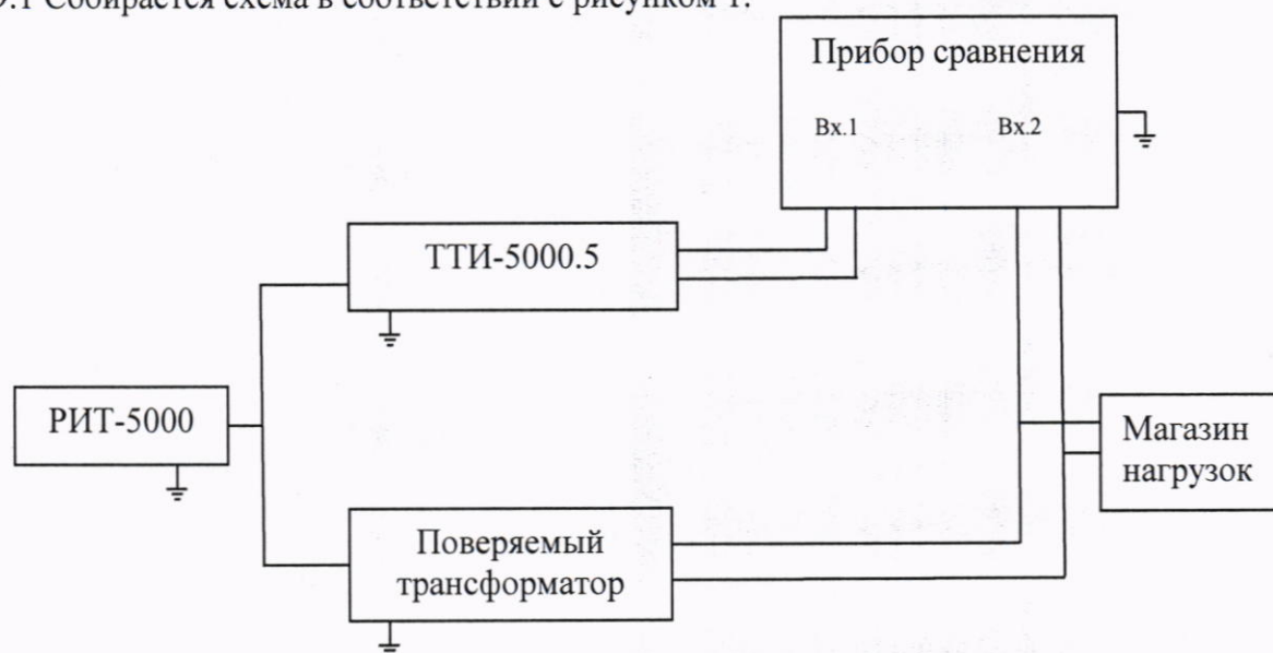
Рисунок 1 – Схема определения токовых и угловых погрешностей трансформаторов
