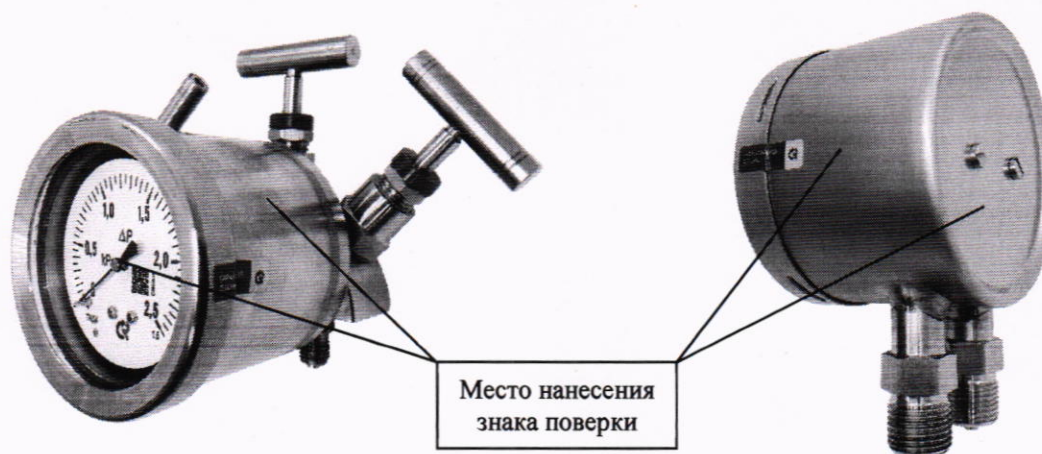
Рисунок 1 – Обозначение возможных мест нанесения знака поверки
