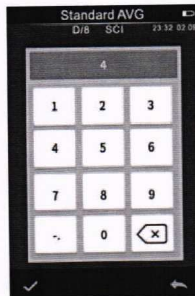
Рисунок 27 – Окно ввода количества измерений для усреднения
