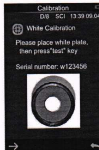
Рисунок 11 – Окно калибровки по белому образцу «White Calibration»
