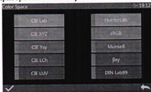
Рисунок 20 – Окно выбора колориметрической системы
