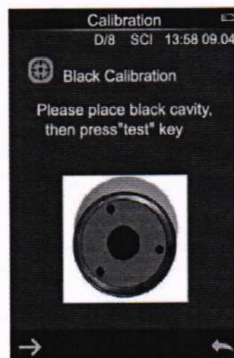
Рисунок 9 – Окно калибровки по чёрному образцу «Black Calibration»
