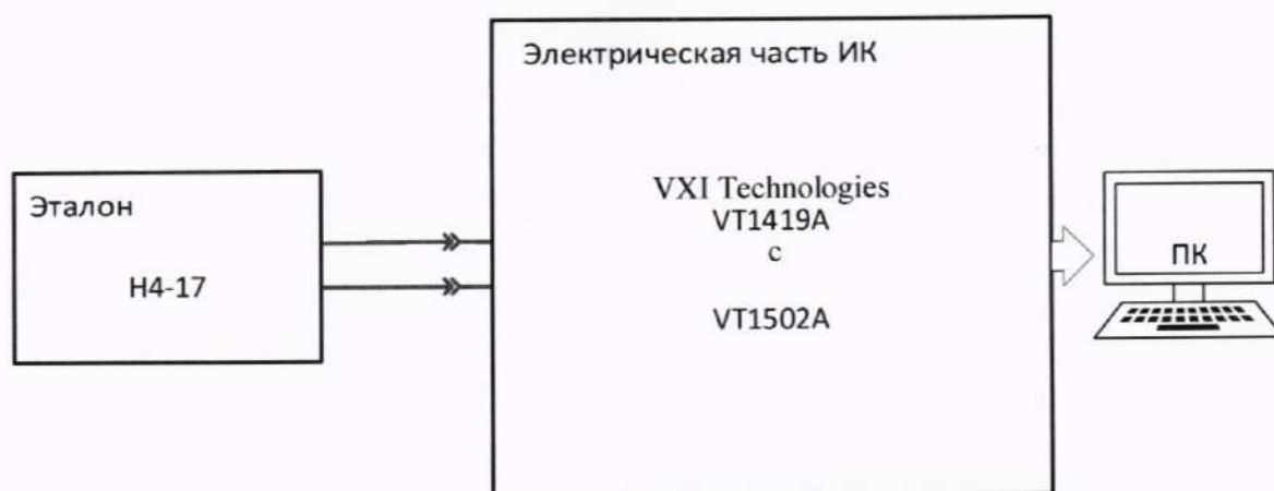
Рисунок 11 – Схема поверки ИК напряжения постоянного тока МИАВ
