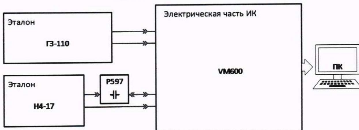
Рисунок 7 – Схема поверки ИК МИВиБ при использовании меры емкости и калибратора напряжения переменного тока
