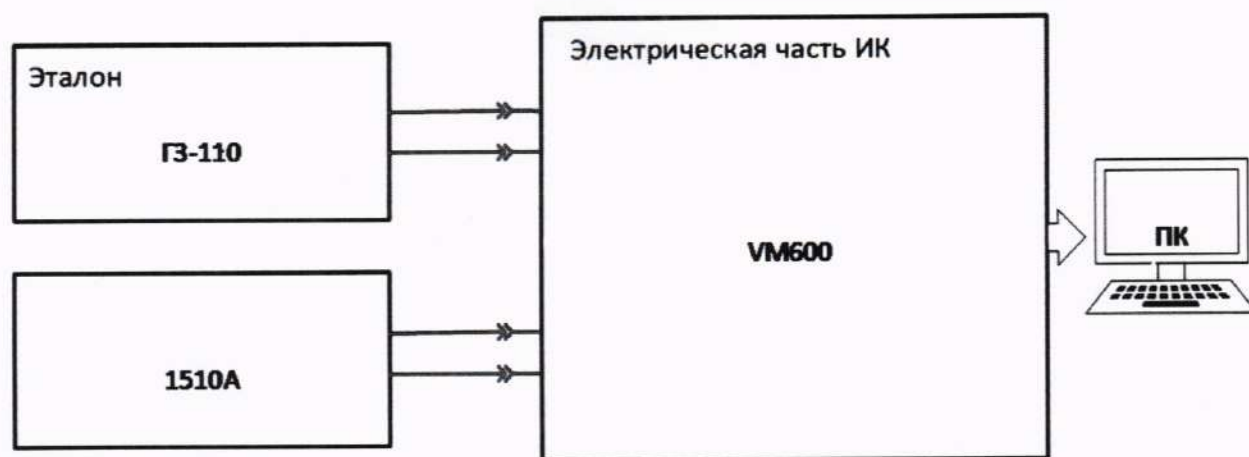
Рисунок 6 – Схема поверки ИК МИВиБ
