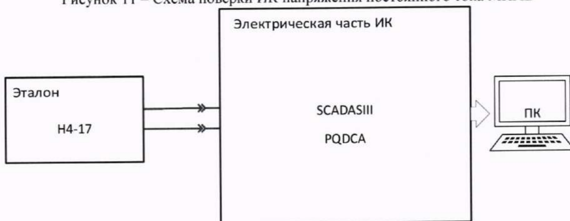
Рисунок 12 – Схема поверки ИК амплитуды напряжения переменного тока МИДП
