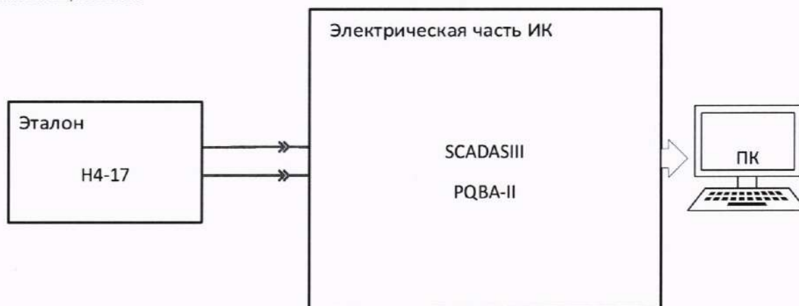
Рисунок 13 – Схема поверки ИК напряжения тензодатчиков
