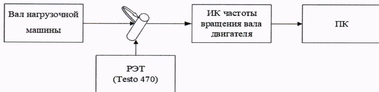
Рисунок 1 - Схема поверки ИК частоты вращения вала двигателя (РЭТ Testo 470)
