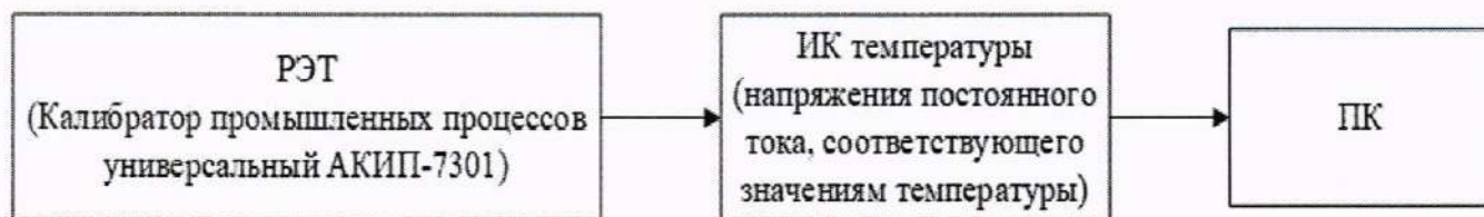
Рисунок 6 - Схема поверки ИК температуры (напряжения постоянного тока, соответствующего значениям температуры), РЭТ калибратор промышленных процессов универсальный АКИП-7301
