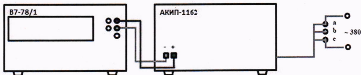
Рисунок 1 – Схема соединения источников при определении абсолютной погрешности установки и измерения напряжения постоянного тока
