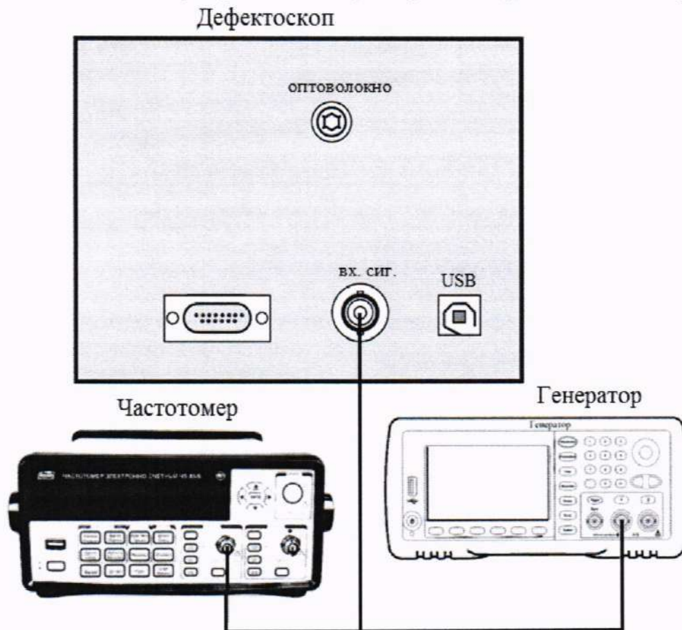
Рисунок 5 – Схема подключения генератора и частотомера для определения диапазона и абсолютной погрешности измерений временных интервалов
