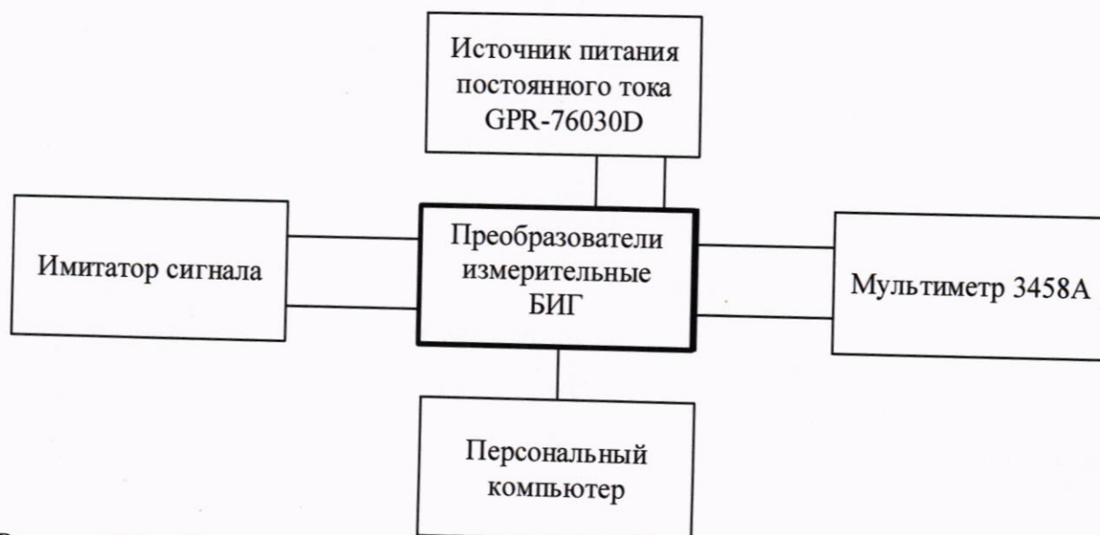
Рисунок А.1 – Схема определения основной приведенной (к верхнему пределу диапазона входного сигнала) погрешности преобразователя Имитатор сигналов - Калибратор многофункциональный и коммуникатор BEAMEX MC6 (-R), Мера электрического сопротивления постоянного тока многозначная MC3070M-1, Генератор сигналов специальной формы АКИП-3409/1
