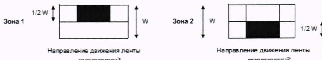
Рисунок 1 — Расположение испытательных нагрузок для СИ
