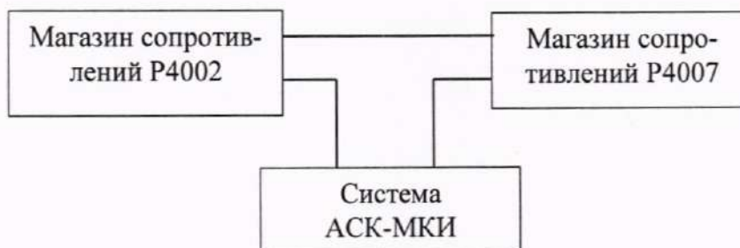
Рисунок 3 – Схема подключения магазина сопротивлений Р4002 и магазина сопротивлений Р4007, соединённых последовательно, к системе
