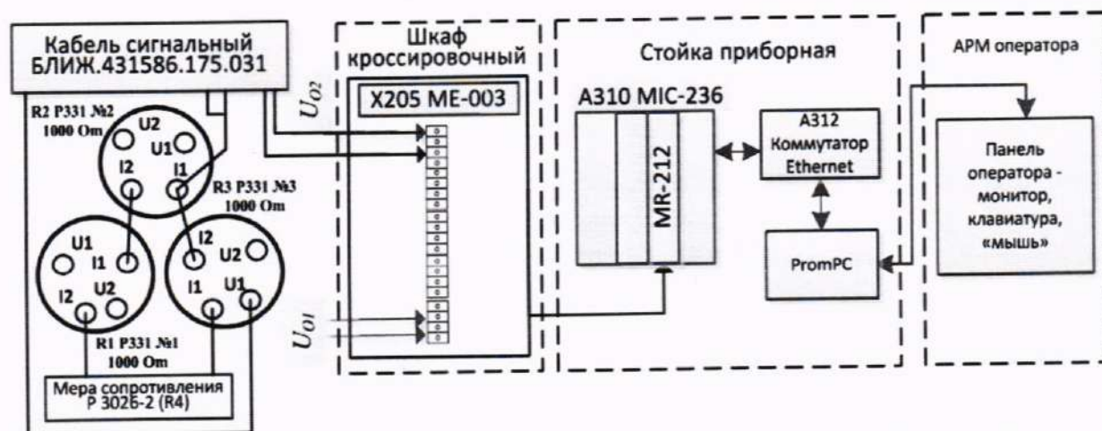
Рисунок 20 – Схема поверки ИК коэффициента преобразования относительного напряжения тензорезистивного моста
