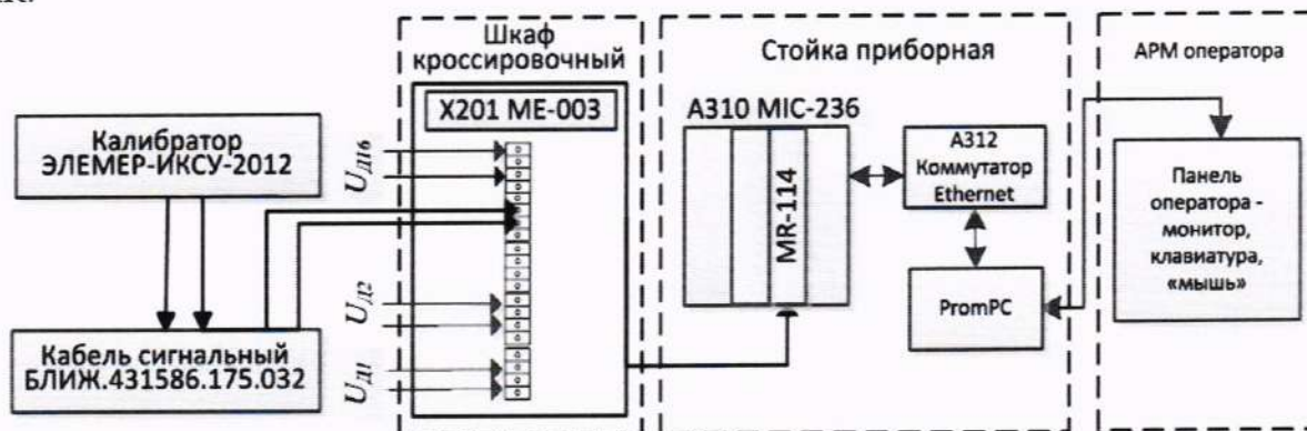
Рисунок 17 – Схема поверки ИК напряжения постоянного тока
