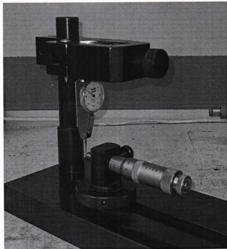
**Рисунок А.1 – Приспособление для определения погрешности индикаторов
