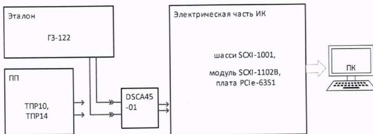
Рисунок 9 – Схема поверки ИК объемного расхода (прокачки) масла (гидросмеси)
