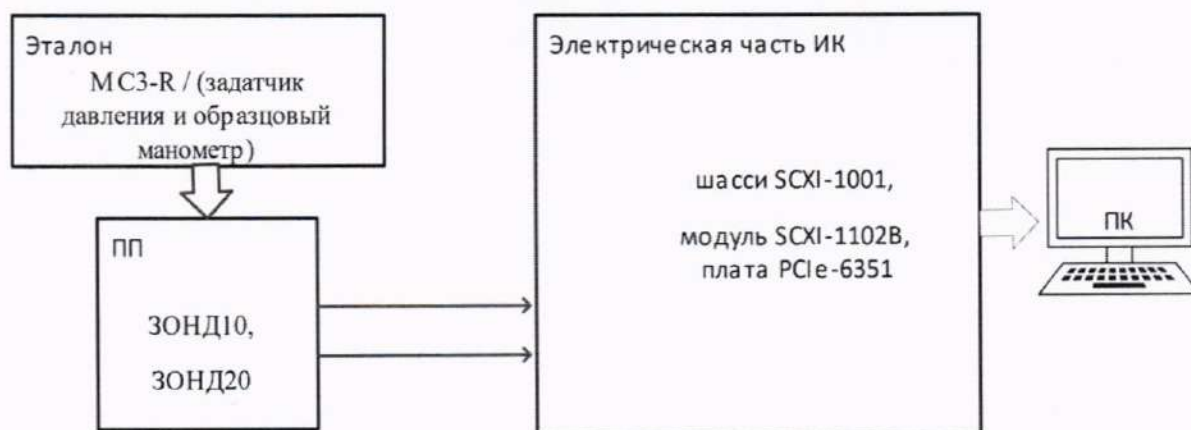
Рисунок 6 – Схема поверки ИК избыточного давления и давления-разряжения газообразных и жидких сред комплектным способом
