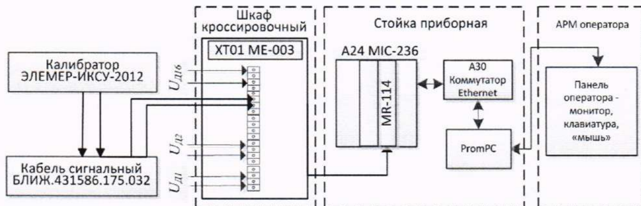
Рисунок 17 – Схема поверки ИК напряжения постоянного тока
