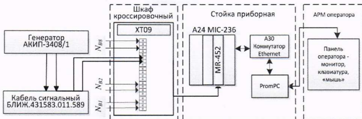
Рисунок 19 – Схема проверки электрической части ИК частоты периодического сигнала
