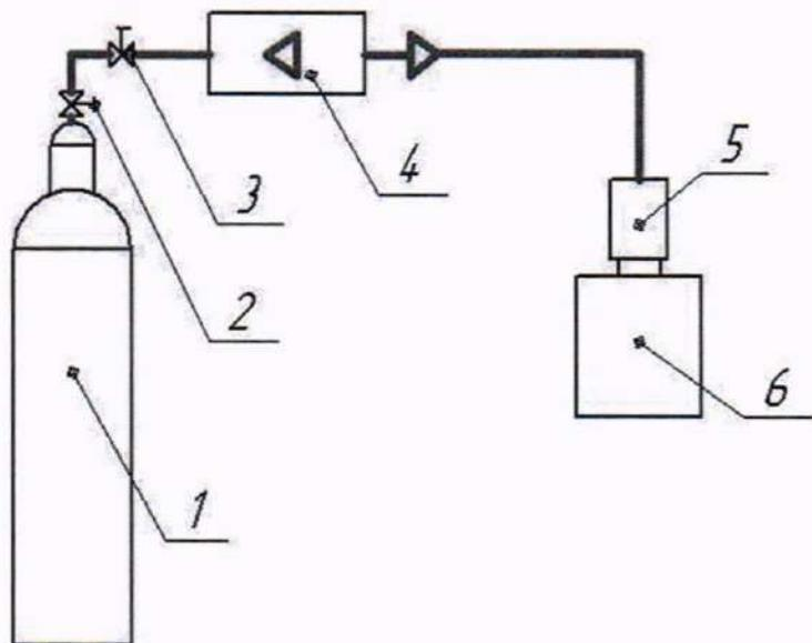
1 – баллон с ПГС; 2 – вентиль; 3 – вентиль тонкой регулировки;
