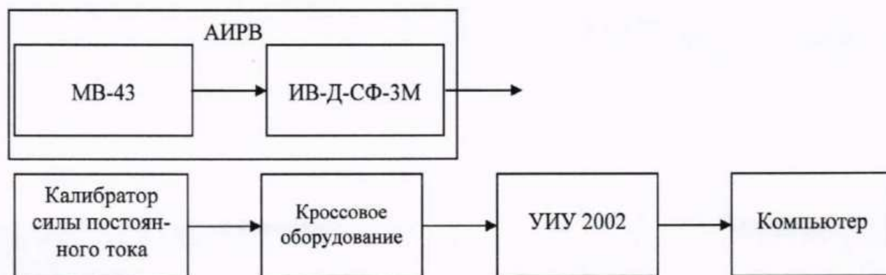
Рисунок 11 - Схема определения метрологических характеристик ИК виброскорости
