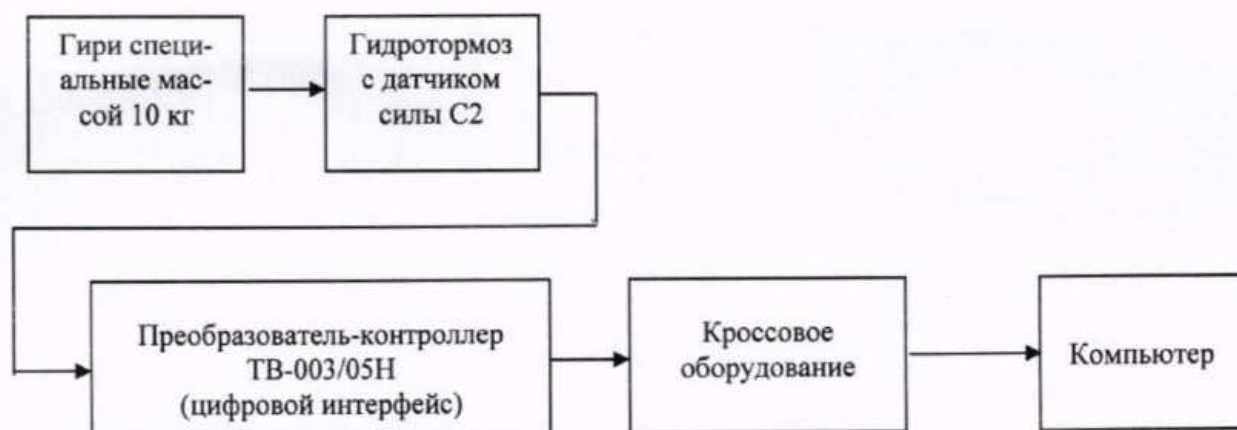
Рисунок 15 - Схема определения метрологических характеристик ИК силы
