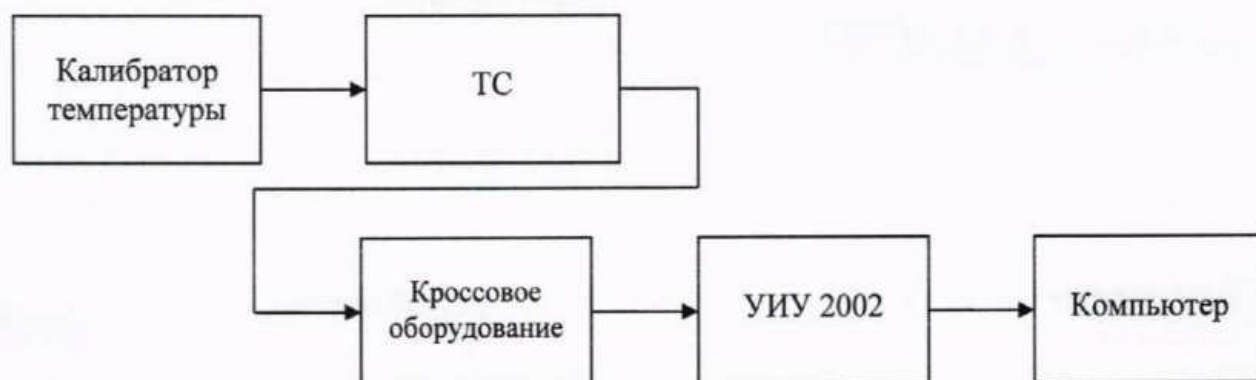
а) Схема определения метрологических характеристик комплектным способом
