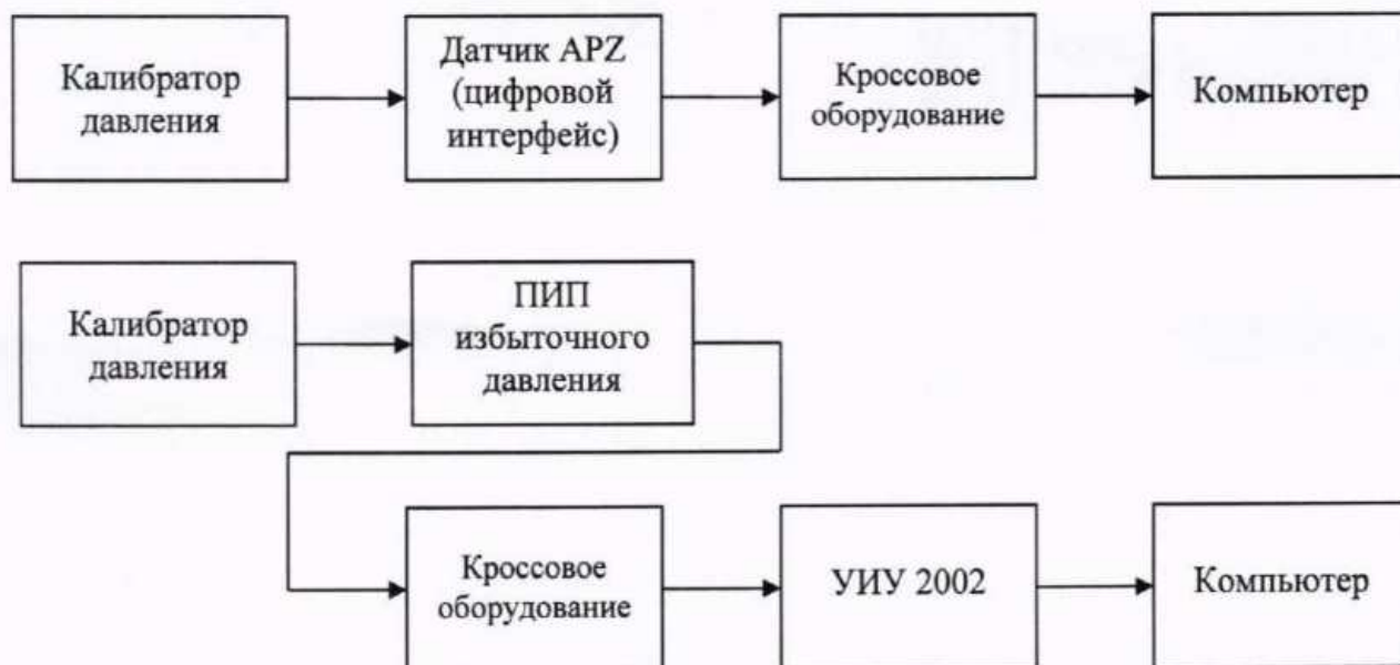
а) Схема определения метрологических характеристик комплектным способом
