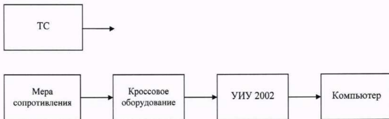
б) Схема определения метрологических характеристик поэлементным способом
