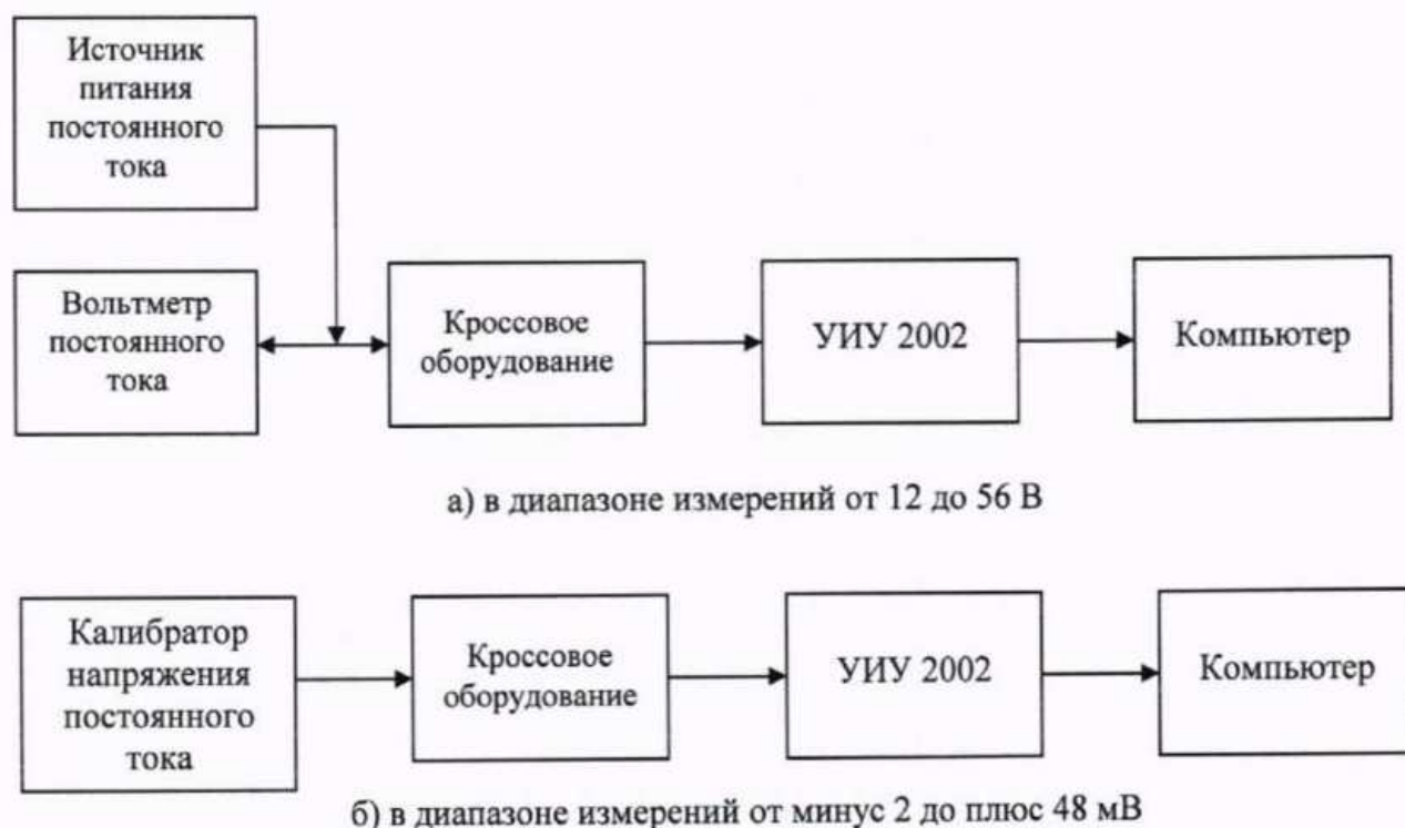
Рисунок 12 - Схема определения метрологических характеристик ИК напряжения постоянного тока
