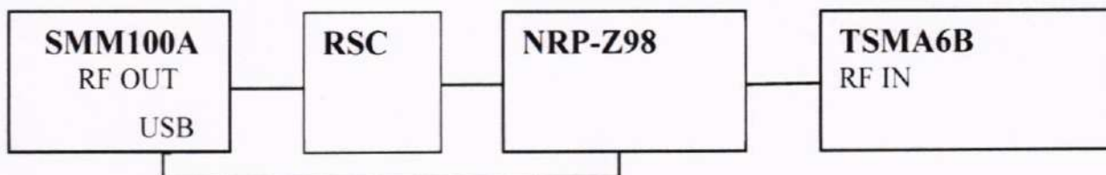
Рисунок 3 - Структурная схема соединения средств измерений для определения абсолютной погрешности измерений уровня мощности входного сигнала в диапазоне от минус 20 до минус 120 дБ (1 мВт)
