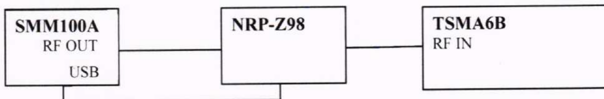
Рисунок 2 - Структурная схема соединения средств измерений для определения абсолютной погрешности измерений уровня мощности входного сигнала минус 20 дБ (1 мВт)
