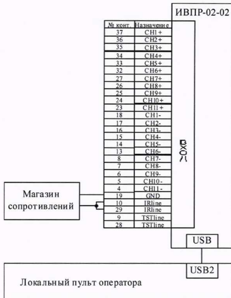
Рисунок Г.2 Схема соединения приборов при определении погрешности каналов измерения сопротивления ИВПР-02-02
