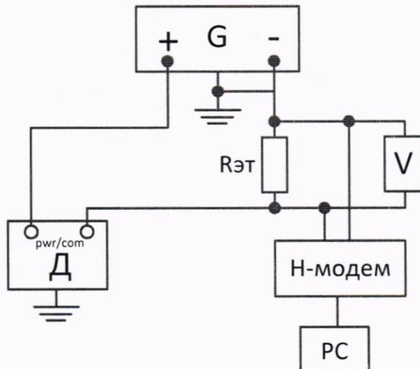
Н-модем – HART-USB модем для связи преобразователя с компьютером;
