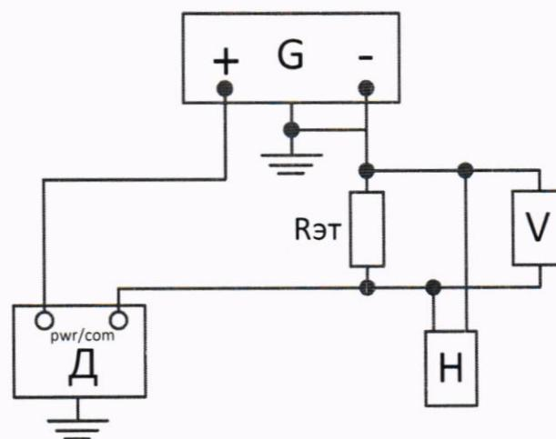
Д – поверяемый преобразователь;
