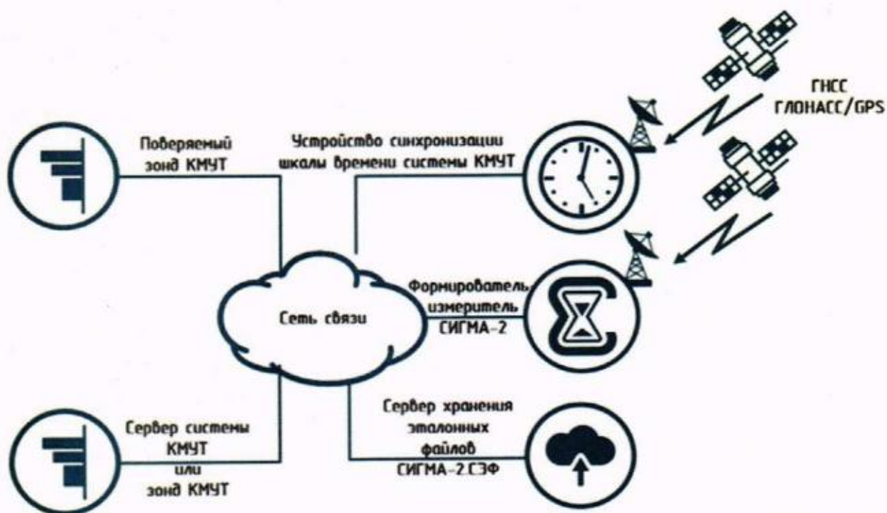
Рисунок 2 – Схема измерений для проведения опробования при первичной поверке
