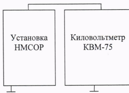
Рисунок 1 – Схема определение погрешности воспроизведений и измерений напряжения постоянного тока
