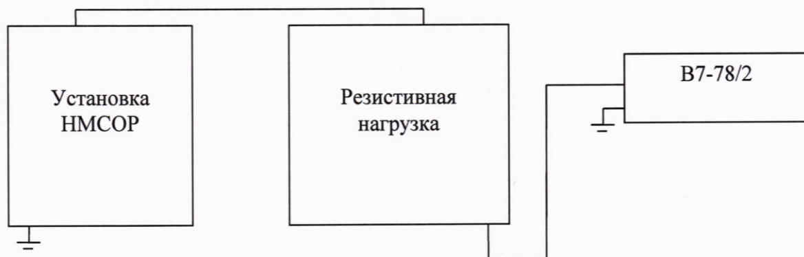
Рисунок 2 – Схема измерений силы постоянного тока
