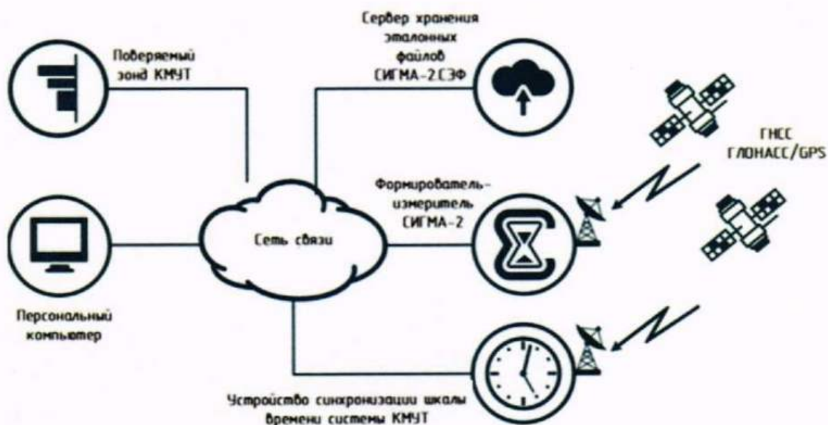
Рисунок 7 – Схема измерений при поверке зонда КМУТ
