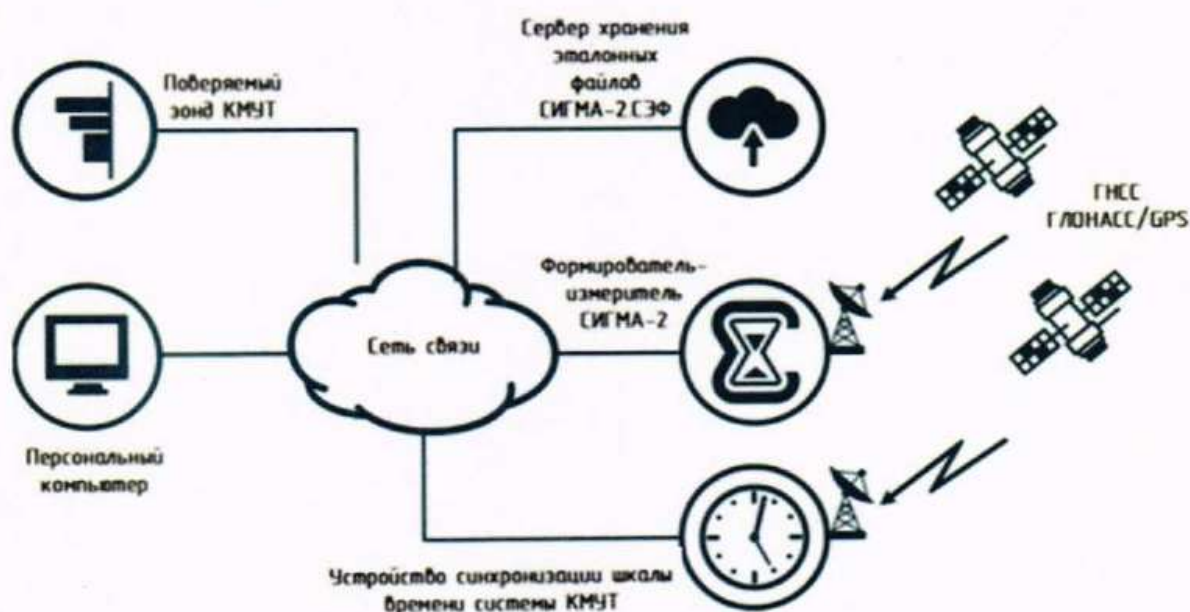
Рисунок 7 – Схема измерений при поверке зонда КМУТ
