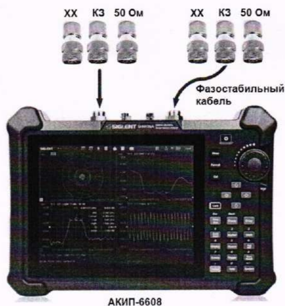
Рисунок 5 – Схема соединения приборов для определения погрешности измерения модуля и фазы коэффициента отражения
