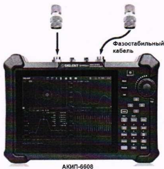
Рисунок 4 – Схема соединения приборов для измерения среднеквадратического отклонения шумов измерительного тракта
