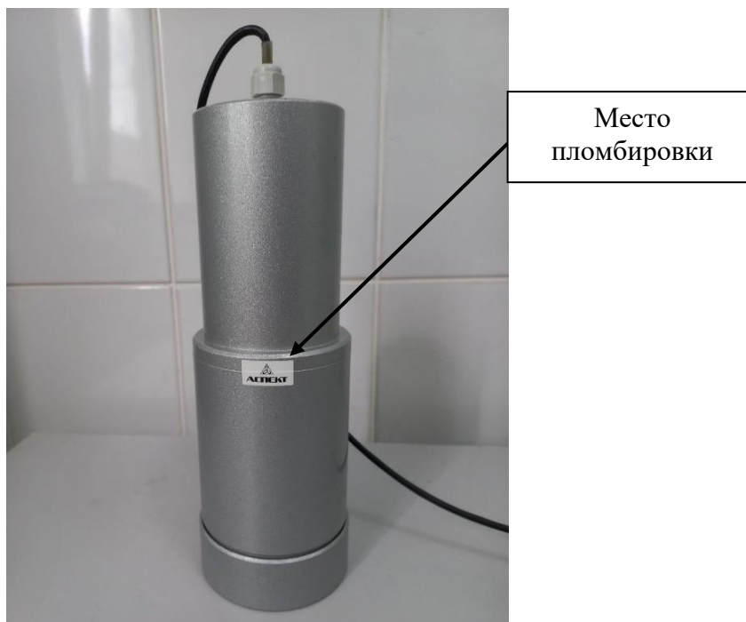
Рисунок 3 – Устройство детектирования УДС-Б-USB из состава спектрометра «БЕТА-1С» с указанием места пломбировки
