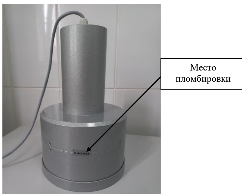
Рисунок 4 – Устройство детектирования УДС-Б-150-USB из состава спектрометра «БЕТА-1С-150» с указанием места пломбировки
