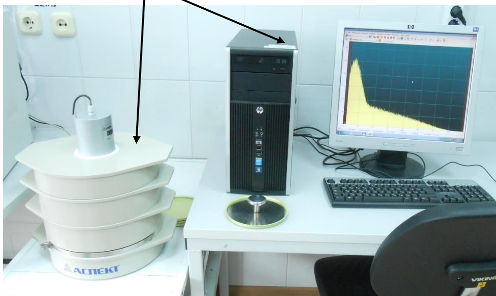
Рисунок 2 – Общий вид спектрометра энергий бета-излучения сцинтилляционного «БЕТА-1С-150» с указанием мест нанесения серийного номера и знака утверждения типа
