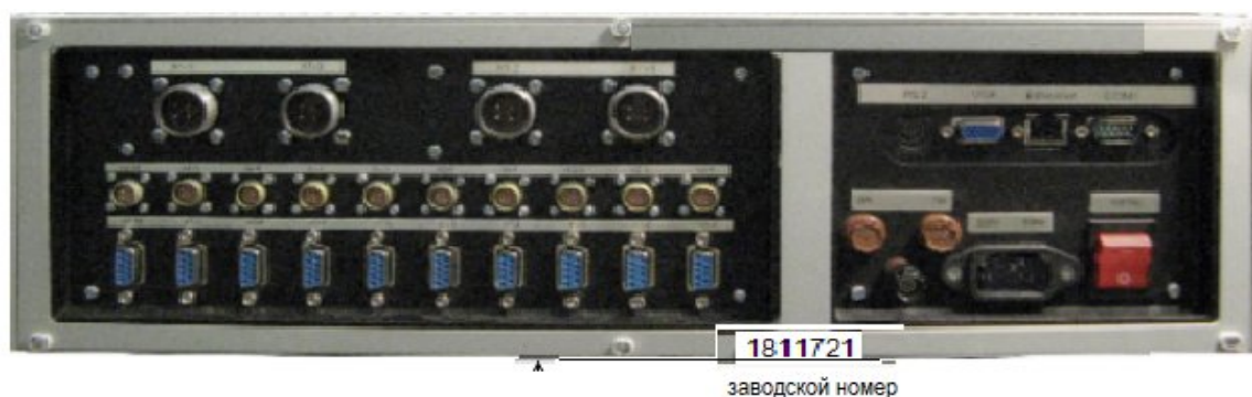
Рисунок 1 – нанесение заводского номера на заднюю панель измерительного блока аппаратуры.
