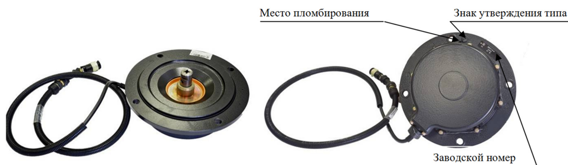
Рисунок 1 – Общий вид датчиков ДПС-У-01, ДПС-У-01.01, ДПС-У-01.02, ДПС-У-08 с указанием места нанесения заводского номера, знака утверждения типа и места пломбирования
