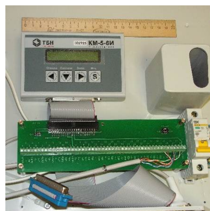
Рисунок 5 – Вычислительное устройство КМ-М-6И (штатное для модификации КМ-5-6И) с платформой подключения
