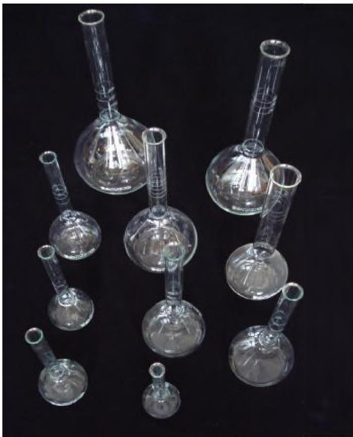
Колба представляет собой стеклянный сосуд сферической формы с плоским или незначительно вогнутым дном и цилиндрической горловиной. На цилиндрической части горловины нанесены три круговые отметки в плоскости перпендикулярной к оси колбы. На колбу вместимостью 500 см<sup>3</sup> наносят пять круговых отметок через 2 см<sup>3</sup>. Колбы градуируют на наливной объем при температуре 20 °C.
