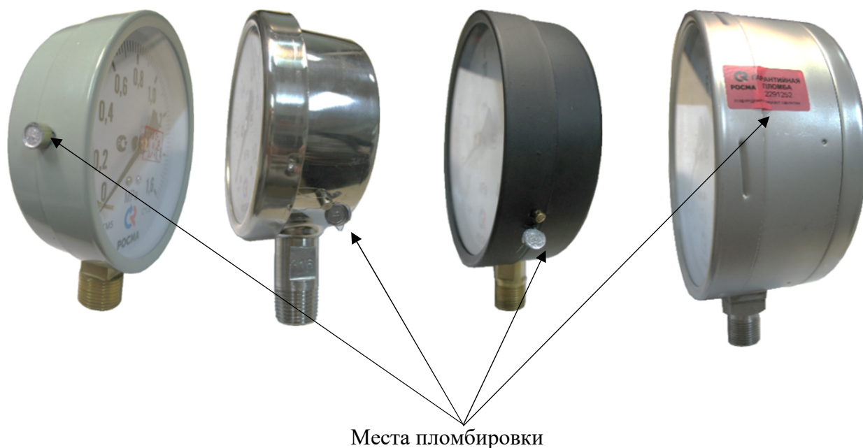
Рисунок 13 – Схемы пломбировки приборов от несанкционированного доступа
