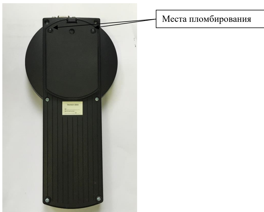
Рисунок 2 – Схема пломбировки от несанкционированного доступа
