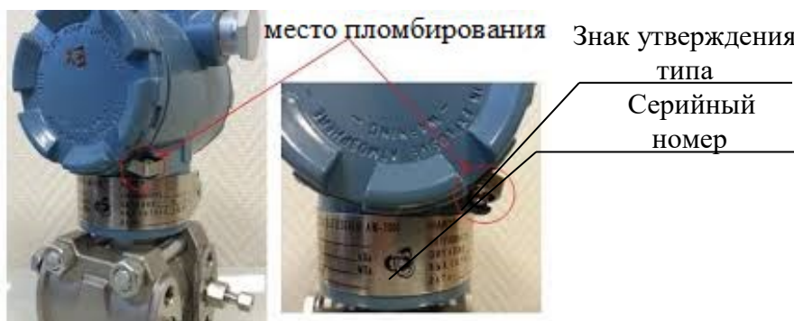
Рисунок 2 – Схема пломбирования датчиков
