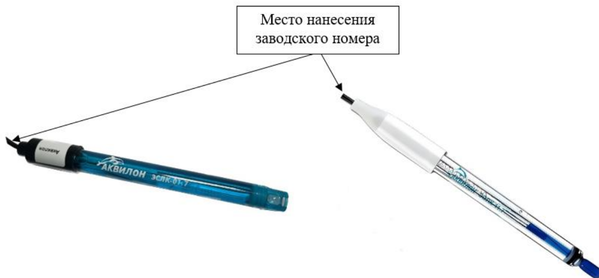
Рисунок 1 – Общий вид электрода исполнения ЭСЛК-01.7 с указанием места нанесения заводского номера
