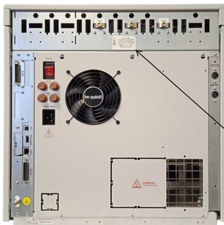
Рисунок 2 – Место нахождения таблички со знаком утверждения типа и заводским номером
