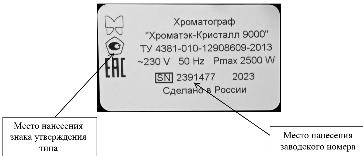
Рисунок 3 – Места нанесения знака утверждения типа и заводского номера
