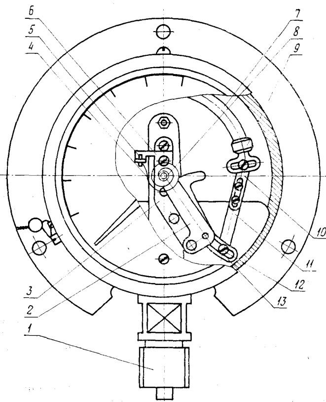
щение трибку 8 с насаненной на ней указательной стрелкой. На трибке с помощью разрезной колодки закреплена спиральная пружина 4, другой конец которой закреплен штифтом 5 в кронштейне 6. Спиральная пружина предназначена для выбора люфтов в зубчатом зацеплении и в шарнирах тяг. Верхняя и нижняя платы механизма скреплены между собой колонками. Весь механизм крепят в держателе винтами.
