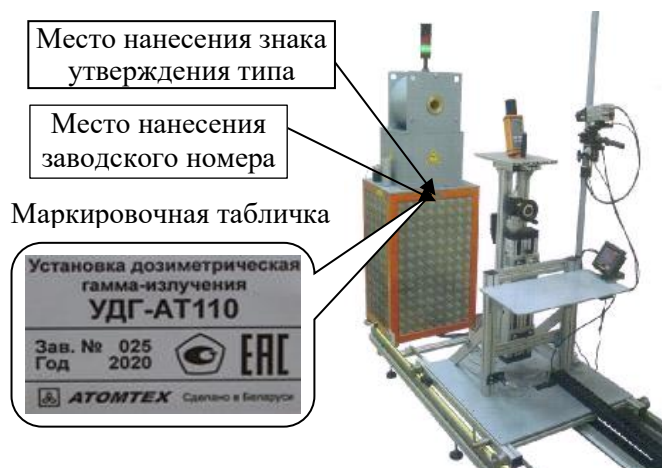
Рисунок 1 – Общий вид установки дозиметрической гамма-излучения УДГ-АТ110
