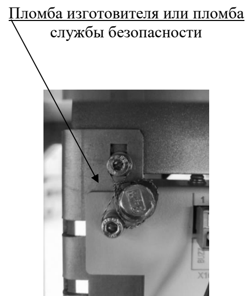
Рисунок 14 – Схема пломбировки узлов крепления блока управления
