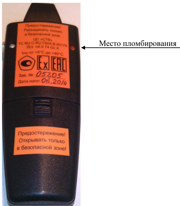
Рис 5. Блок измерительный тахометров оптических ДО-03-01, ДО-03-02, ДО-03-03, ДО-03-04. Вид со стороны крышки корпуса
