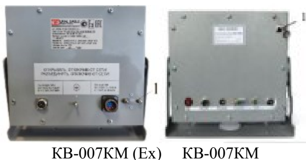
Рисунок 11 – Схема пломбировки приборов весоизмерительных KB-007KM (Ex), KB-007KM (1 – свинцовая, пластиковая или мастичная пломба)
