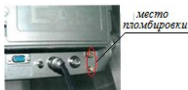
Рисунок 12 – Схема пломбировки прибора весоизмерительного CI-200A(S/SC)
