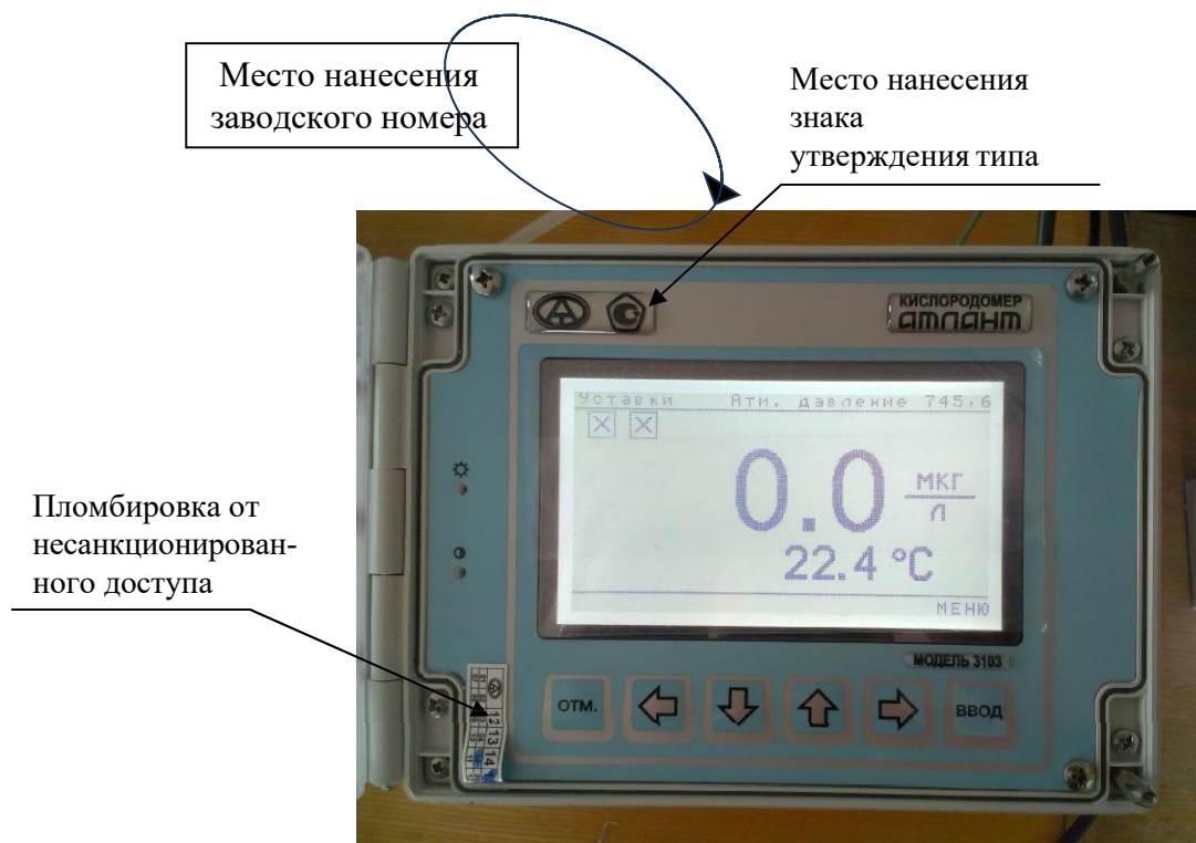
Рисунок 1 – Внешний вид измерительного блока кислородомера, с указанием мест размещения знака утверждения типа, заводского номера и пломбирования от несанкционированного доступа
