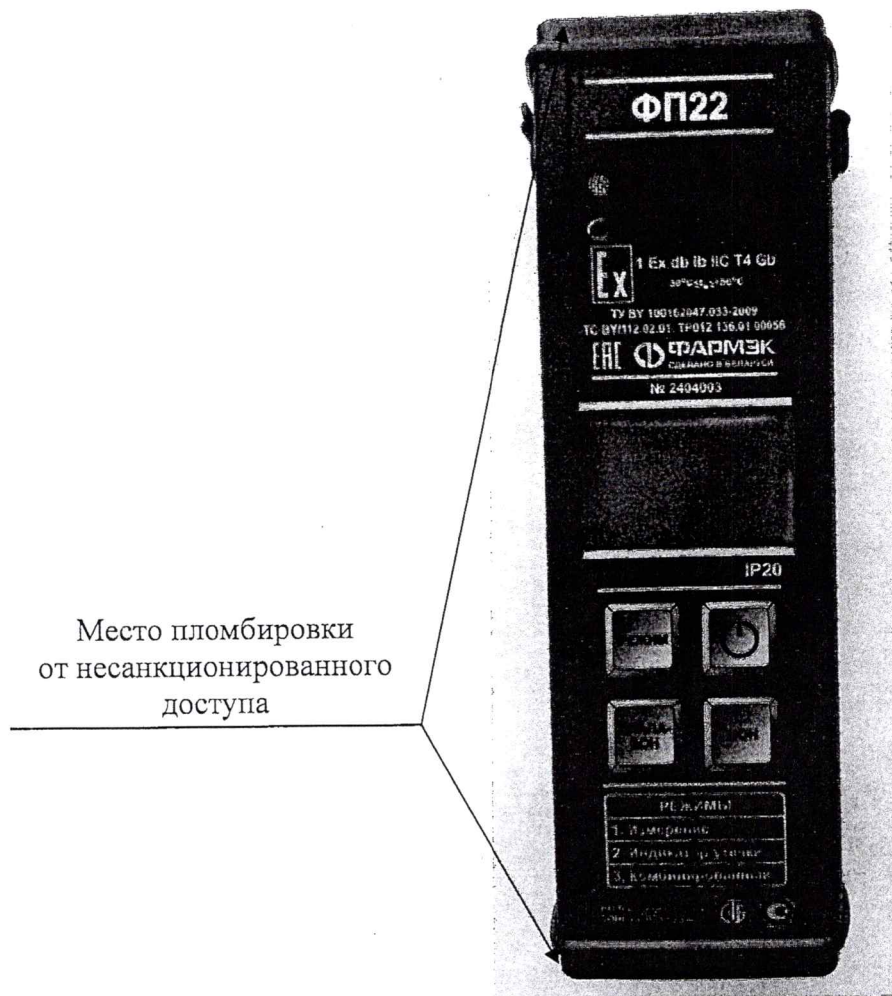
Рисунок 3.1 – Схема пломбировки от несанкционированного доступа
