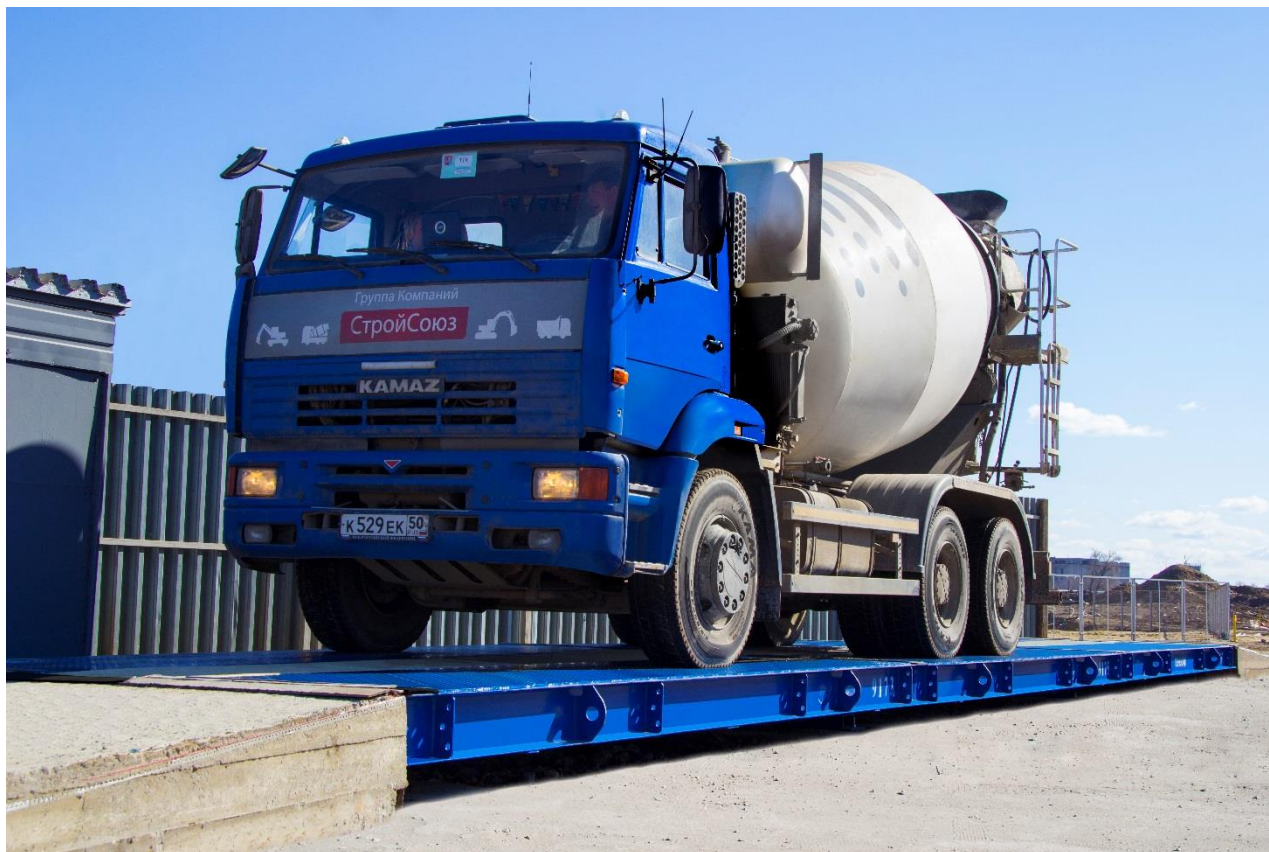
Рисунок 1 – Внешний вид весов ВА с установкой ГП над поверхностью дорожного полотна
